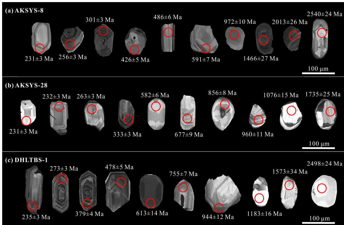
图 4 西昆仑阿克萨依矿区巴颜喀拉山群典型碎屑锆石 CL 图像及测点年龄
