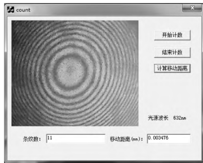
图 10 干涉条纹自动计数系统
