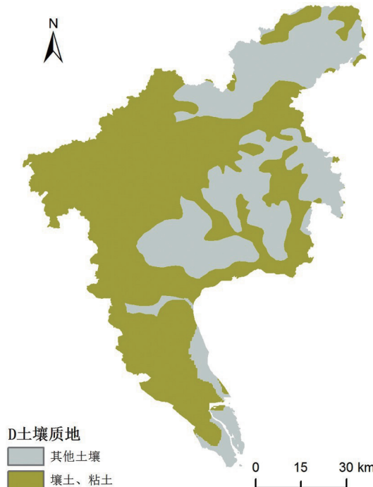
图 5 GIS 人工湿地选址筛选因素“D 土壤质地”示意图 (审图号: GS(2015)2583)
