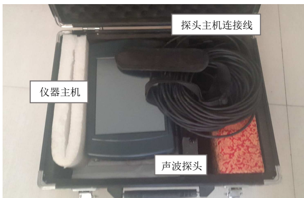
图 9 RSM-SY5(T)型非金属声波检测仪
