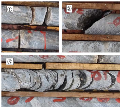
①—原始节理；②—打钻破坏节理；③—卸荷风化节理
