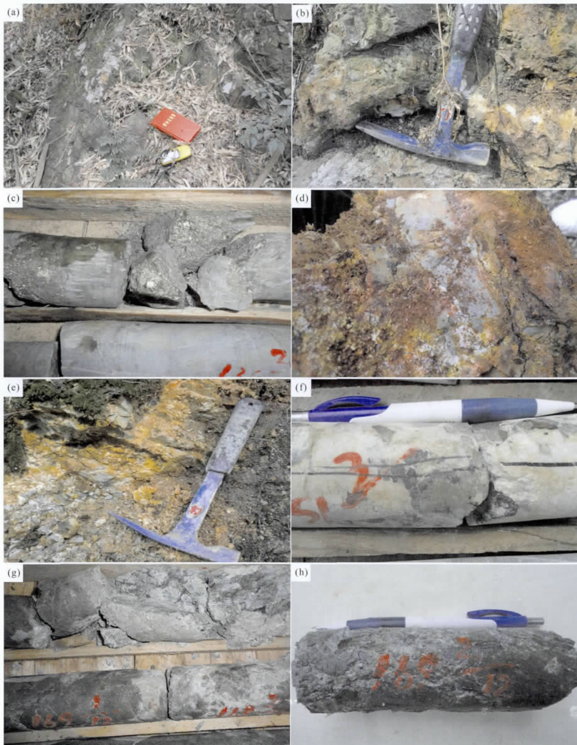
(a) 1 号脉蚀变岩露头; (b) 2 号脉蚀变岩露头; (c) 1 号脉黄铁矿化粉砂质碎裂岩; (d) , (e) 5 号脉蚀变岩露头; (f) 含黄铜及闪锌矿石英脉; (g) , (h) 黄铁矿化花岗质碎裂岩。
