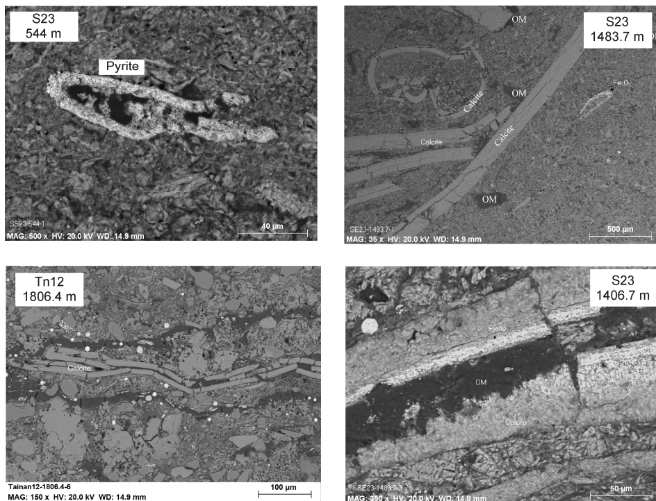
图 2 柴达木盆地三湖地区第四系弱成岩阶段生物化学-有机-无机相互作用造成的大量自生矿物沉淀 OM-有机质; Calcite-方解石; Pyrite-黄铁矿
