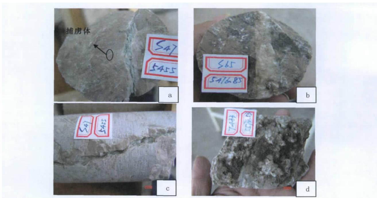
图4 裂缝充填状况图
