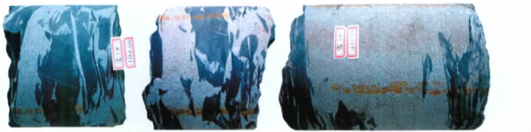
图5 地震形成的岩层破碎带(海拉尔盆地霍3井)
