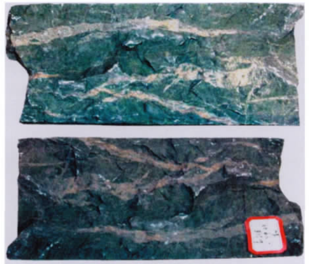
图 3 岩心中的灰绿色泥岩震裂脉 Fig. 3 Seismic crack filling vein in grey green mudstone observed at the core 古 708 井:充填物为泥质粉砂
