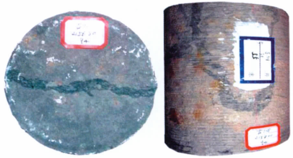
图 2 岩心中的砂岩震裂脉 Fig. 2 Seismic crack filling vein in sandstone observed at the core 古 708 井:充填物为粉砂质泥
