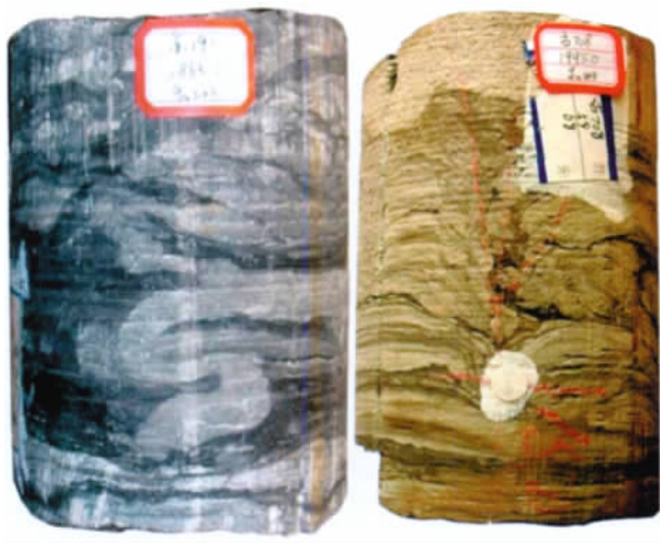
图 10 折弯砂脉岩心照片 Fig. 10 Core photo showing bending of sand vein
