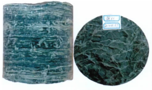
图 11 絮状砂脉岩心照片 Fig. 11 Core photo showing flocculent sand vein
