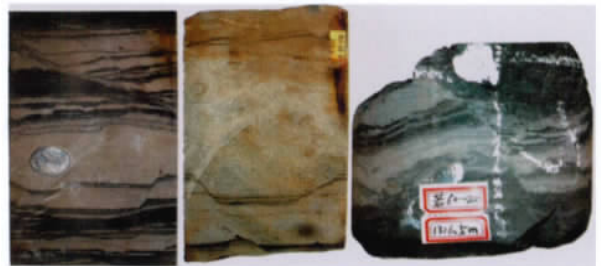
图 4 岩心中的微型断层 Fig. 4 Micro-faults observed at the core
