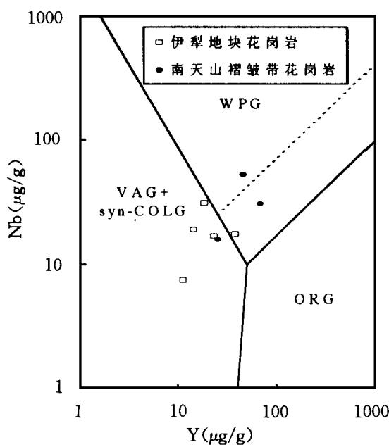
图4 Nb-Y 和 Ta-Yb 构造判别图解 (据Pearce *et al.*, 1984)
